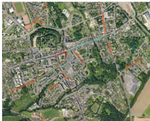
La Ville de Gisors a renouvelé et réhabilité 2,8 km de réseaux d'assainissement (en orange) et 1,2 km de réseaux d'eau potable (en bleu)
